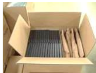
緩衝材の使用例
